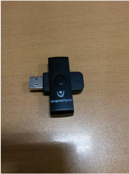
Al conectar el lector al puerto USB de la computadora, se instalarán los drivers. Una luz verde parpadeante indicará que el lector está listo para ser usado. En este momento se debe insertar la CI en el lector, de la manera que se ve en la imagen siguiente (chip hacia arriba):
